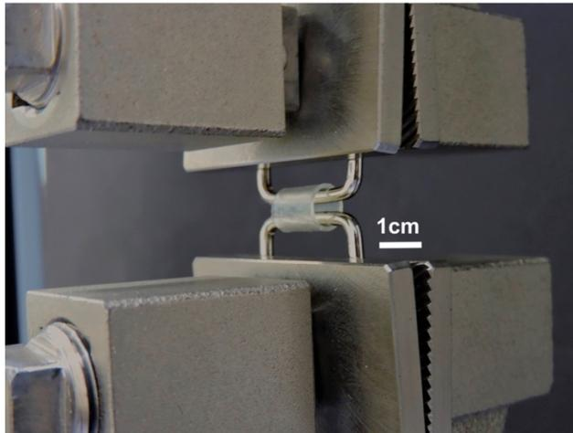
Figura 3.9 Prueba de tensión circunferencial en una probeta en forma de anillo.
