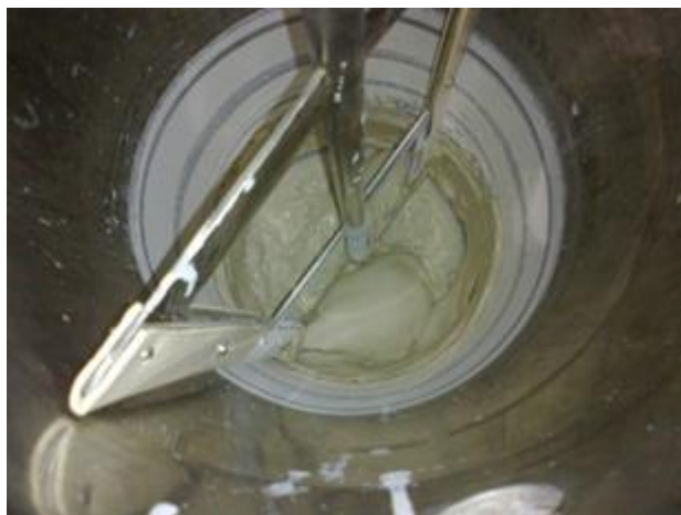
Figura 3.3. Apariencia de la Paligorskita durante la etapa de evaporación cuando el sistema de agitación se detiene.
