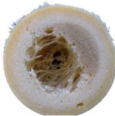
Figura 3.11. Espuma de PP a 150 rpm, 1 % de agente espumante, 4 % de PPma y 190 °C, con un tiempo de enfriamiento de 8 min (prueba 6).
