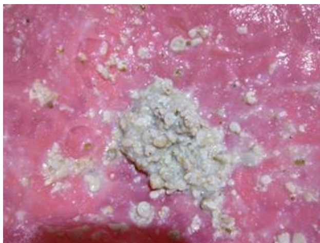
Figura 3.2. Residuos pétreos y sólidos del lote 2 retenidos en la malla de filtración.
