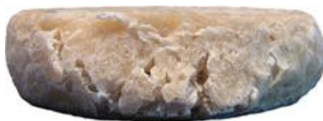
Figura 3.54. Probeta 2 del cilindro 2 con 8 % de Paligorskita ensayada a compresión.
