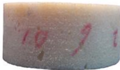
Figura 3.50. Probeta 4 para compresión de la espuma E2-0 con 0 % de arcilla.
