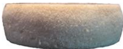
Figura 3.51. Probeta 4 del cilindro 2 con 0 % de Paligorskita ensayada a compresión.
