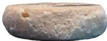
Figura 3.53. Probeta 3 del cilindro 1 con 6 % de Paligorskita ensayada a compresión.
