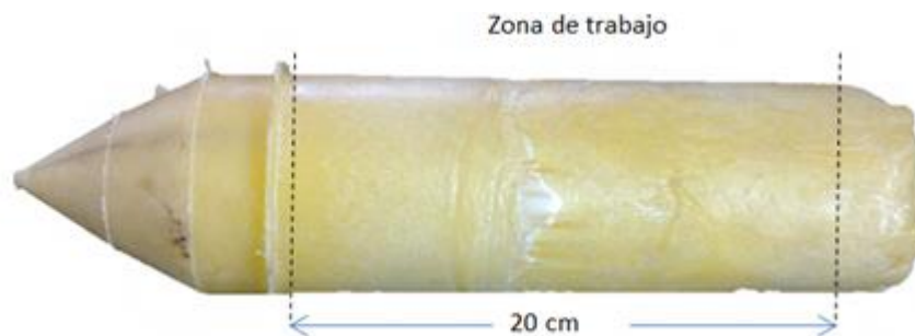
Figura 3.13. Cilindro 7, replica 1, espumado de PP a 150 rpm, 190 °C, 8 % PPma y 1.5 % agente espumante.
