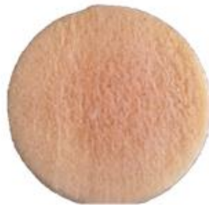
Figura 3.12. Espuma de PP a 150 rpm, 190 °C, 4 % de PPma y 1 % de agente espumante con un tiempo de enfriamiento de 30 min.
