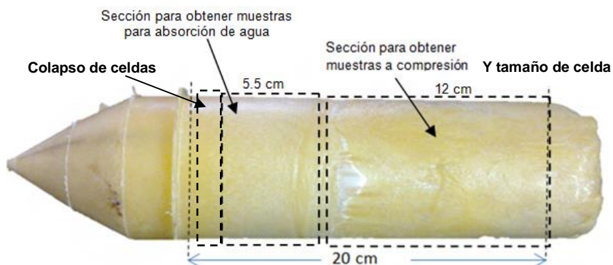
Figura 3.35. Espuma de PP/Pal con 0 % de arcilla mostrando las secciones para la caracterización.
