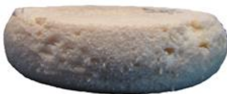
Figura 3.52. Probeta 2 del cilindro 1 con 1 % de Paligorskita ensayada a compresión.
