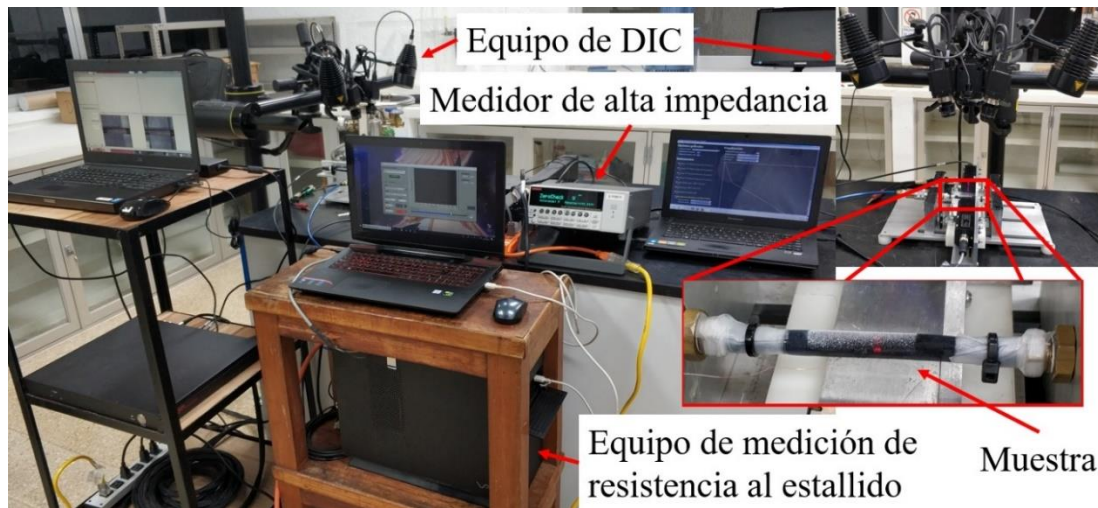
Figura 2.9. Ensayo piezorresistivo de resistencia al estallido de tubos. a) Tubo de nanocompuesto y esquema de medición piezorresistiva, b) fotografía del sistema experimental del ensayo. Dimensiones en mm.
