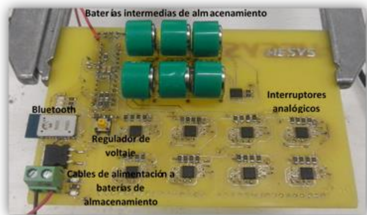
Figura 2.5. Tarjeta HESYS propiedad de CICY (Patente PCT-IB2015-059184).
