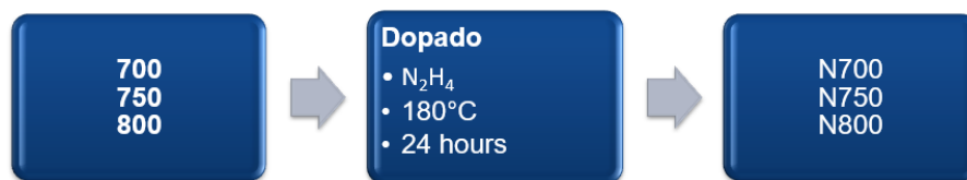
Figura. 16 Diagrama del proceso de obtención de N700, N750 y N800.
