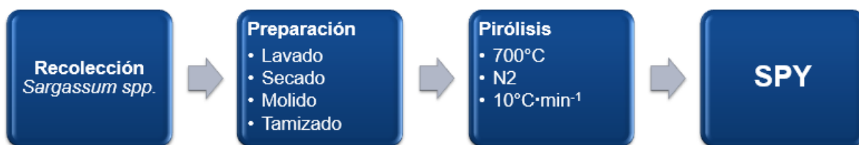
Figura. 10 Diagrama del proceso de obtención de SPY.
