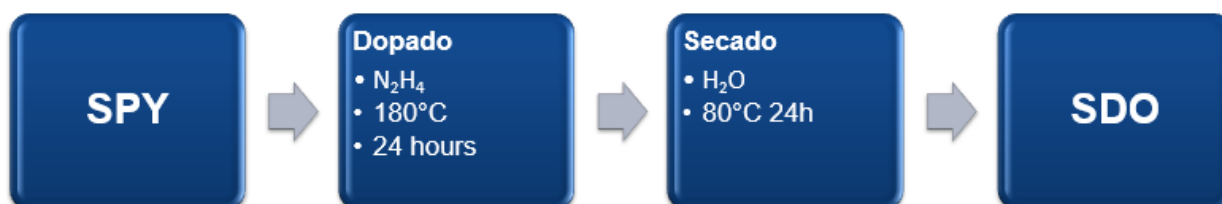
Figura. 11 Diagrama del proceso de obtención de SDO.
