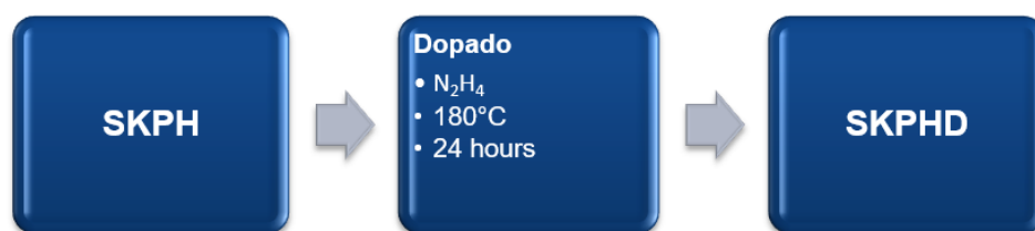
Figura. 14 Diagrama del proceso de obtención de SKPHD.
