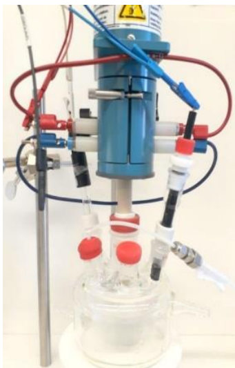
Figura. 25 Montaje de celda electroquímica.
