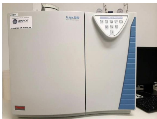
Figura. 19 Equipo de análisis elemental CHNS.
