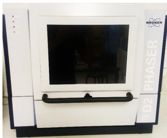
Figura. 23 Equipo de XRD Bruker D2 Phaser.
