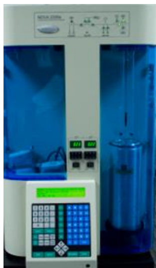
Figura. 20 Equipo de análisis de área superficial Quantachrome Nova 2200e.
