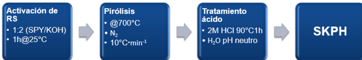
Figura. 13 Diagrama del proceso de obtención de SKPH.
