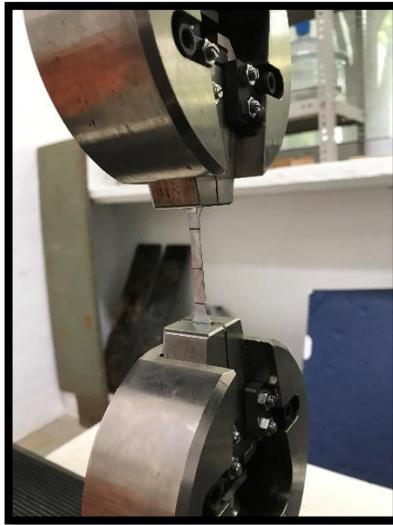
Figura 2.15. Configuración de la prueba de tensión de la lámina de acero.
