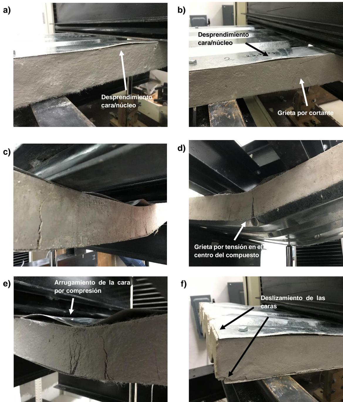
Figura 3.21. Modos de falla de los paneles tipo sándwich durante la prueba de flexión a 4 puntos: a) Desprendimiento cara/núcleo, b) Falla por cortante del núcleo y desprendimiento cara/núcleo, c) Falla por cortante por debajo del cargador, d) Falla por tensión del núcleo en la mitad del panel, e) Arrugamiento de la cara superior y desprendimiento, f) Deslizamiento de la caras del panel.
