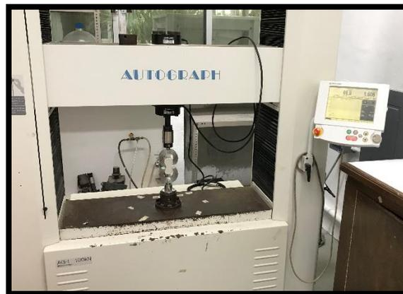
*Figura 2.7. Configuración para la prueba de tensión.*
