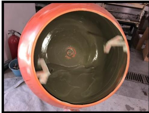
*Figura 2.3. Preparación del mortero.*
