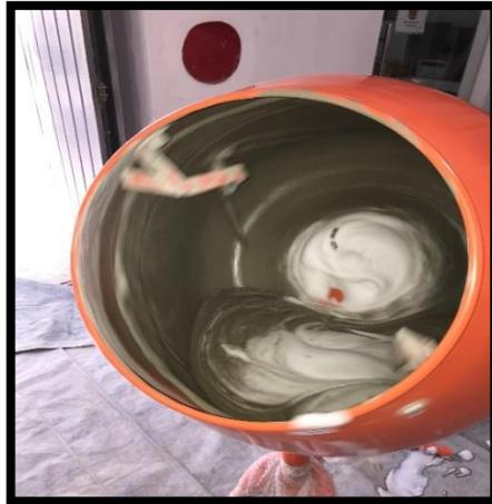
*Figura 2.4. Proceso de mezclado del mortero con la espuma.*
