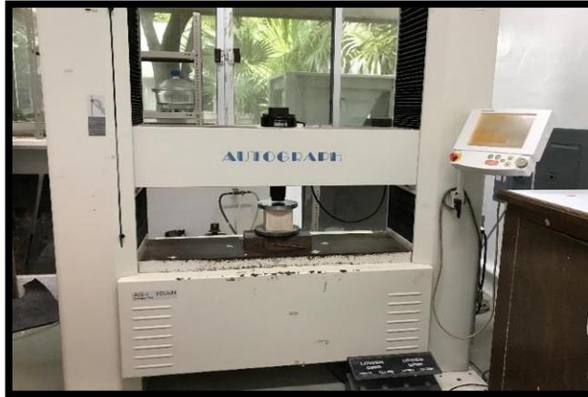
*Figura 2.6. Configuración de la prueba de compresión uniaxial.*
