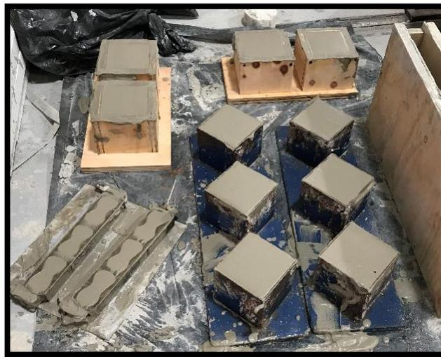
*Figura 2.5. Elaboración de especímenes para pruebas mecánicas.*
