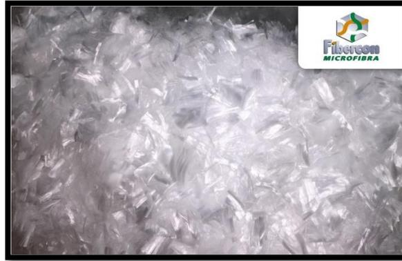
Figura 1.2 Fibra comercial de polipropileno Fibercon [24].
