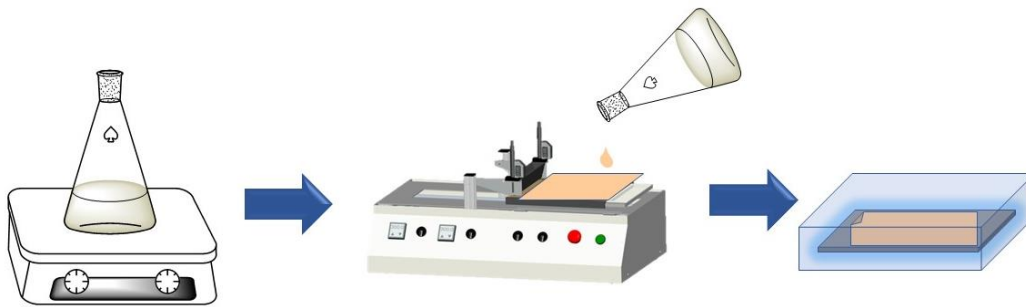
Figura 2.6. Proceso de elaboración de membranas por inversión de fases
