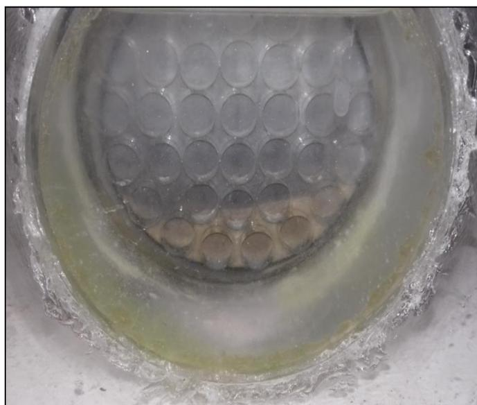
**Figura 3.20.** Precipitado obtenido en la cámara catódica del sistema electroquímico microbiano.
