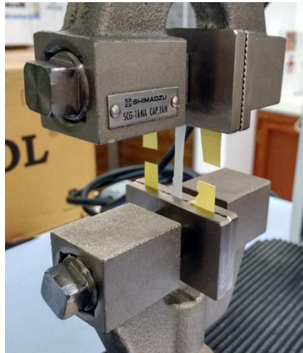
Figura 2.5.-Ensayos mecánicos a tensión de andamios electrohilados de PCL/PLGA.
