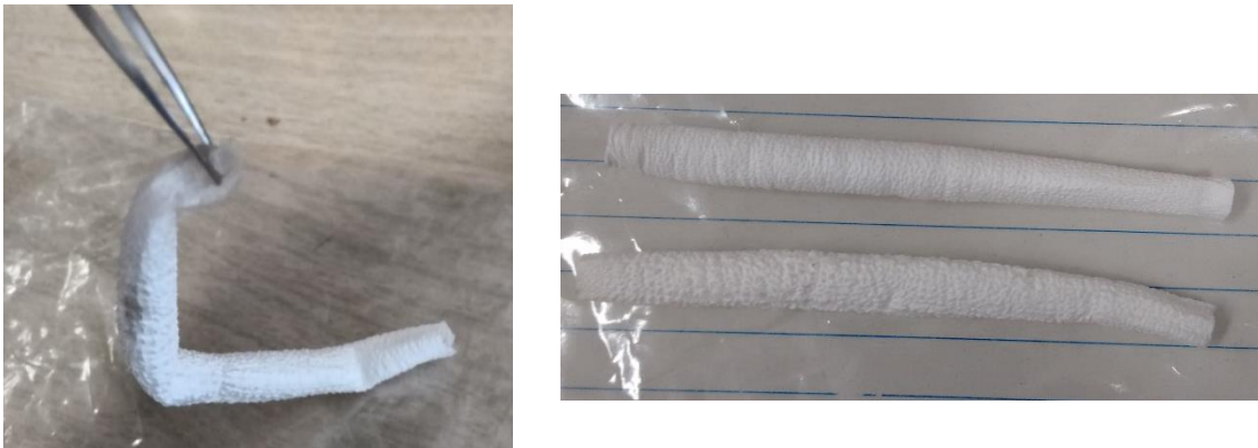
Figura 3.1.-Andamios tubulares de PCL obtenidos mediante electrohilamiento
