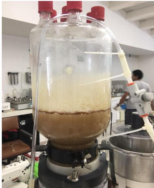
**Reactor aireado usado para la preparación de los extractos enzimáticos**
