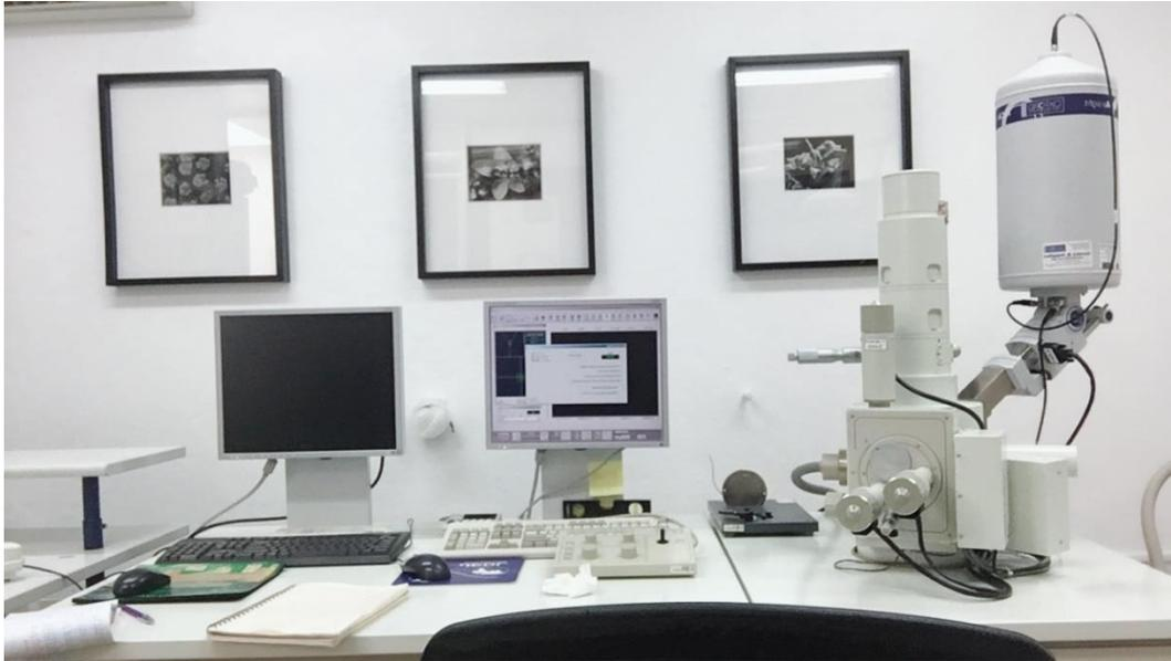
**Microscopio Electrónico de Barrido (MEB).
