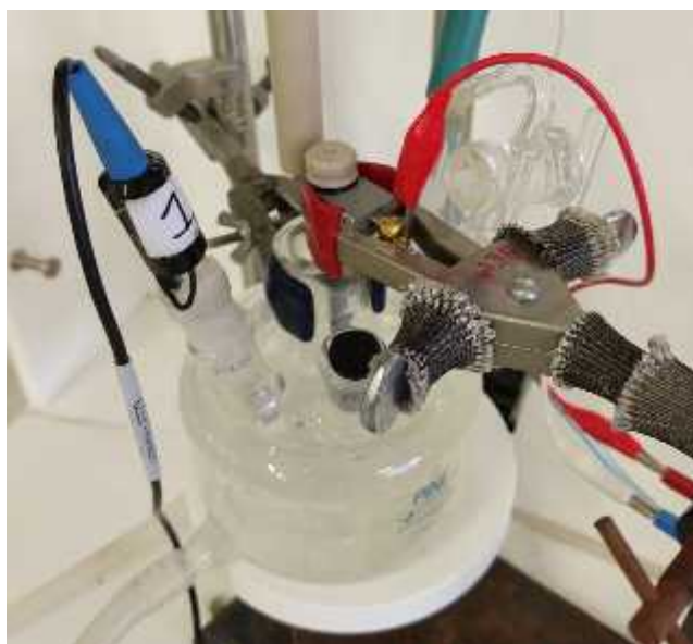
Figura 2.13 Celda de 3 electrodos con electrodo de referencia calomel saturado (cable negro), contra electrodo de alambre de platino (cable blanco) y electrodo de trabajo de 2 mm (cable rojo).
