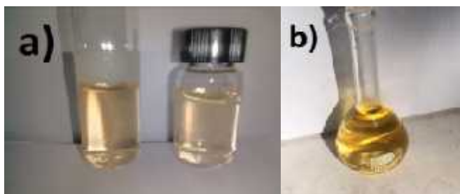
Figura 3.1 a) Muestra de dilución acuosa 1:5 SPtNPs5 (izquierda), muestra de dilución acuosa 1:100 SE100 (derecha) y b) dilución acuosa 1:10 de PtCl 4 10.
