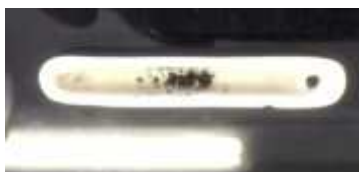
Figura 2.4 Muestra de NPs después del tratamiento térmico a 400°C por 2 horas en atmosfera de nitrógeno.
