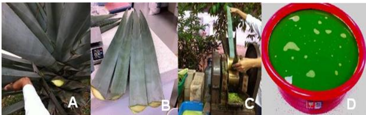
Figura 3.1. Esquema metodológico para la obtención del jugo de hojas de henequén. A) Corte de las hojas. B) Limpieza y medición de las hojas. C) Proceso de extracción en el molino de tres masas. D) Jugo extraído.
