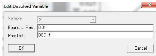
Figure B6 el cuadro de dialogo "Edit Dissolved Variable" se emplea para especificar las propiedades de los sustratos disueltos.
