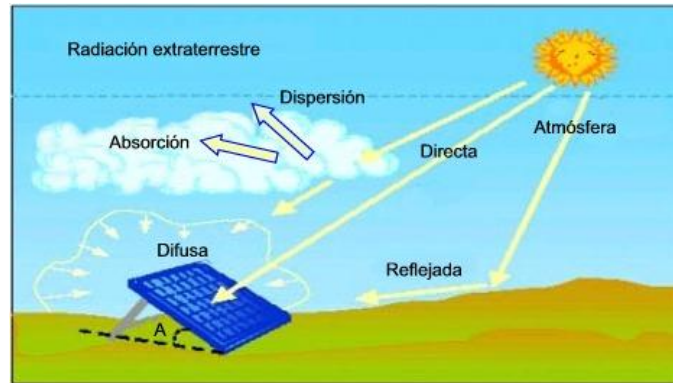
Figura 5. Tipos de Radiación percibida en la Tierra [19]
