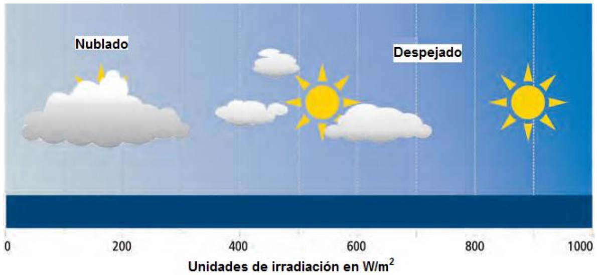
Figura 33. Irradiación solar global a diferentes tipos de cielo [53]
