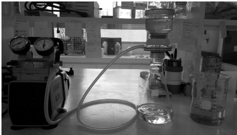
Figura 14. Fotografía del sistema de filtración por adsorción-elución utilizado para este estudio (UCIA, 2018).
