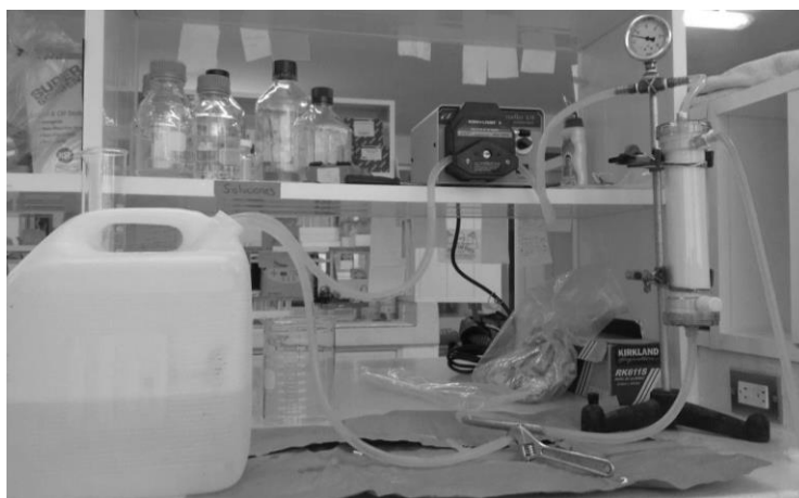
Figura 12. Fotografía del sistema de ultrafiltración tangencial utilizado para este estudio (UCIA, 2018).
