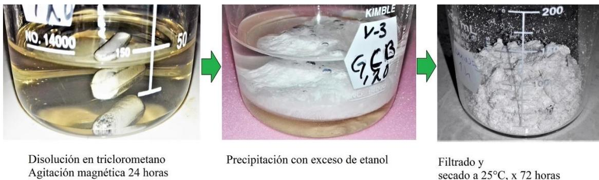
**Figura 2.4.** Proceso de recuperación y limpieza del polímero después de la molienda mecanoquímica.
