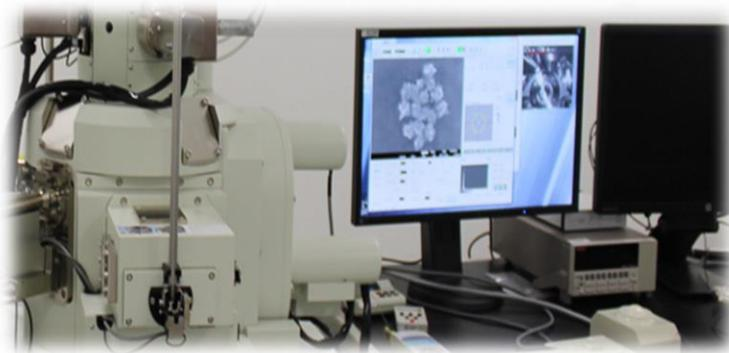
*Figura 2.3 Microscopio electrónico - JEOL-JSM-6360LV*
