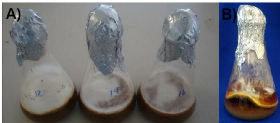
**Figura. 3.3.** Producción de etanol a partir de una suspensión de harina de semillas de ramón, *Brosimum alicastrum*, en un BPC. A) 120 h después de inoculación con 12, 14 y 16% p/v, y B) 288 h después de inoculación con 14% p/v.
