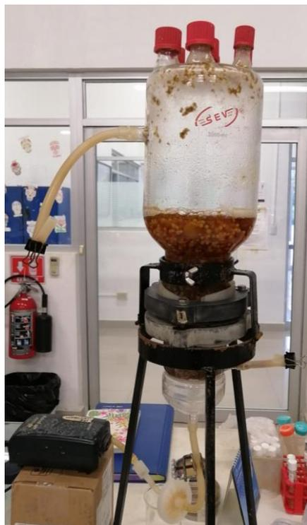
**Figura 2.1.** Producción de extracto enzimático por *T. hirsuta* Bm-2 en un reactor tipo Airliff de 2 L, utilizando HSR/agua al 5% (p/v) como sustrato.
