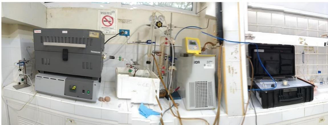
**Figura 2.8.** Sistema utilizado para realizar la Pirolisis de la biomasa leñosa, de izquierda a derecha: Horno tubular, sistema de enfriamiento y analizador de gases.
