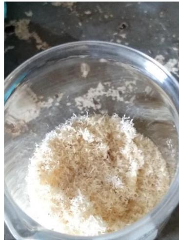
**Figura 2.5.** Hidrólisis ácida para determinación de holocelulosa **Figura 2.6.** Holocelulosa de *L. leucocephala*
