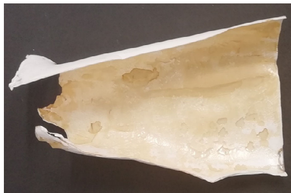
Figura 3.6 Membrana asimétrica compuesta por método de impregnado superficial.
