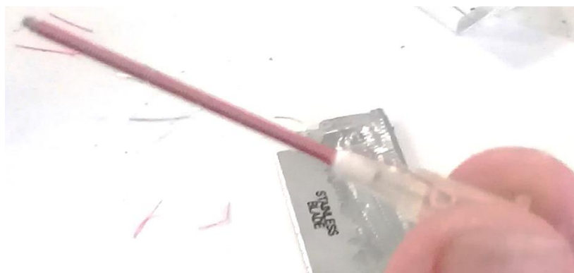
Figura 6. Embobinado de constantán en la aguja; sensor caliente.
