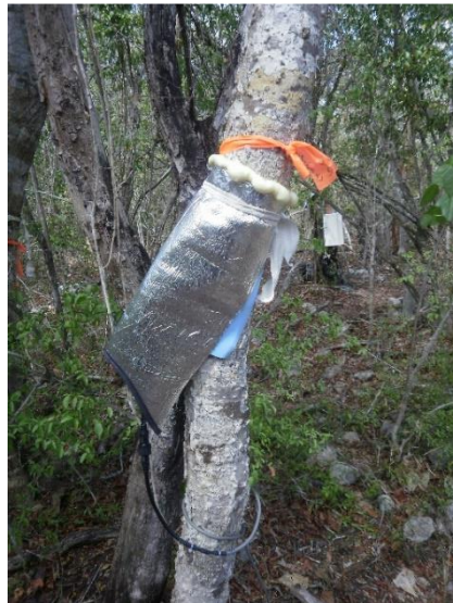
Figura 10. Aislamiento del sensor con anti reflejante y poliuretano.
