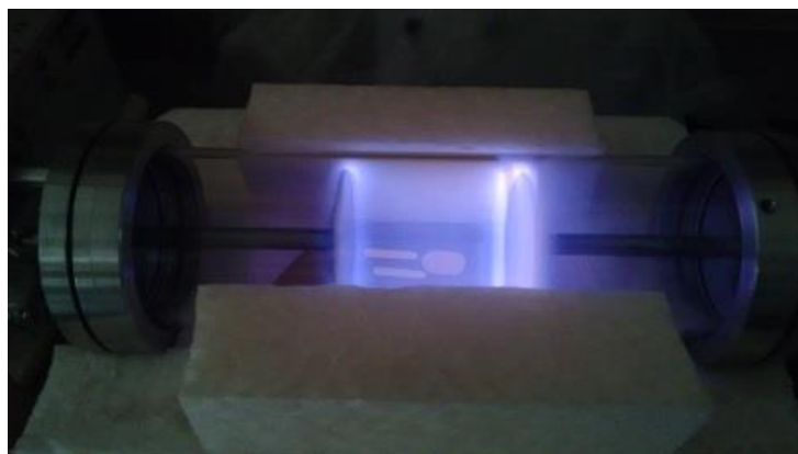
Figura 1.8 Reactor de plasma (proceso de activación de la superficie); el color azul indica la ionización del gas presente.
