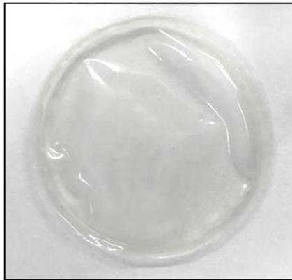
**Figura 3.9** Membrana elaborada a partir de PAMPS-*b*-PMMA.
