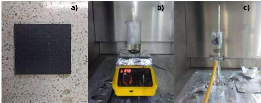
Figura 2.4. a) Muestra para procedimiento de digestión, b) procedimiento de digestión y c) lavado de las fibras en el vaso de sinterizado.
