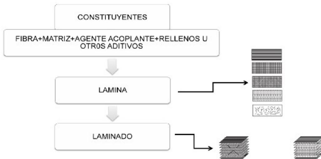
Figura 1.2. Representación esquemática de los materiales compuestos laminados [47].
