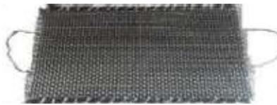
Figura 2.1. Colocación del tejido de carbono en la criba para su oxidación.
