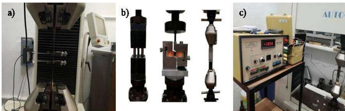
Figura 2.12. a) Prueba de tensión con extensómetro, b) Prueba de compresión, cortante y de resistencia en la unión y c) Equipo de medición mediante galgas extensiométricas.
