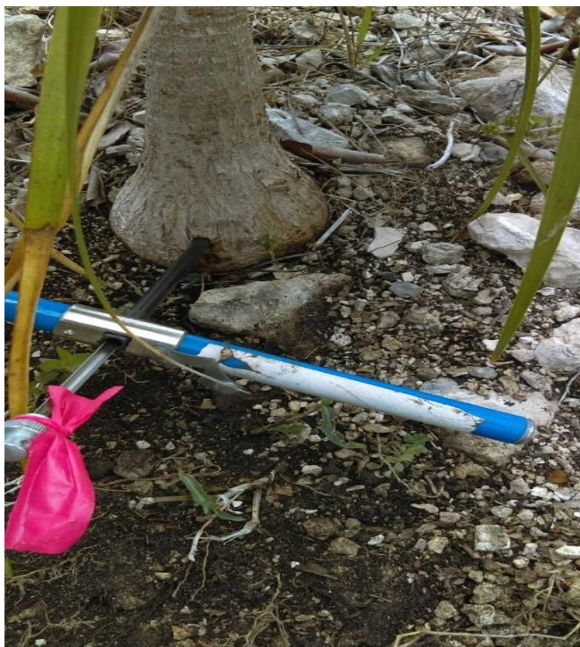
Figura 2.3 Extracción de núcleos de la base del tallo con el taladro de Pressler.
