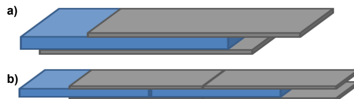
Figura 2.12. Traslape doble a) una pieza (un núcleo y dos caras de aluminio desfasadas), b) unión de dos piezas.
