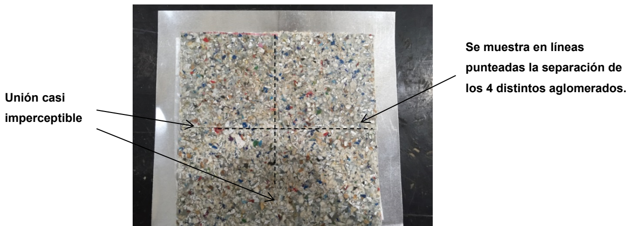
Figura 3.13. Unión de cuatro núcleos con una cara de aluminio.
