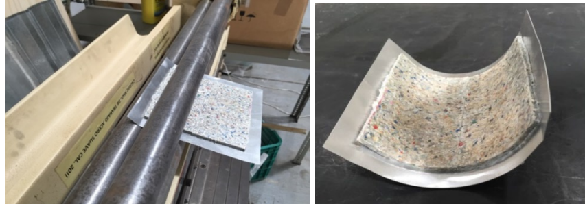
Figura 3.15. Rolado de laminado de una cara de aluminio, hasta un radio de 6 cm de curvatura.
