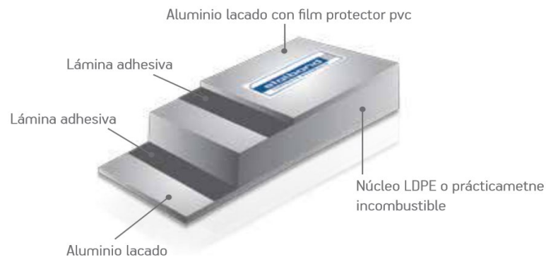
Figura 1.7. Estructura comercial tipo sándwich de aluminio con núcleo de polietileno [24].
