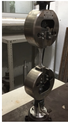
Figura 2.23. Montaje de probeta a tensión en máquina de pruebas universal.
