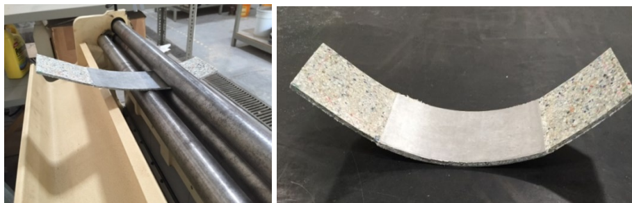
Figura 3.16. Rolado de estructura tipo sándwich hasta 14 cm de radio de curvatura.
