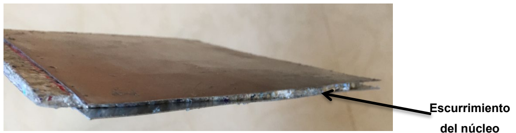
Figura 3.12. Estructura tipo sándwich desfasado para técnica de unión, observando el escurrimiento del núcleo, dentro del espacio generado para el traslape.
