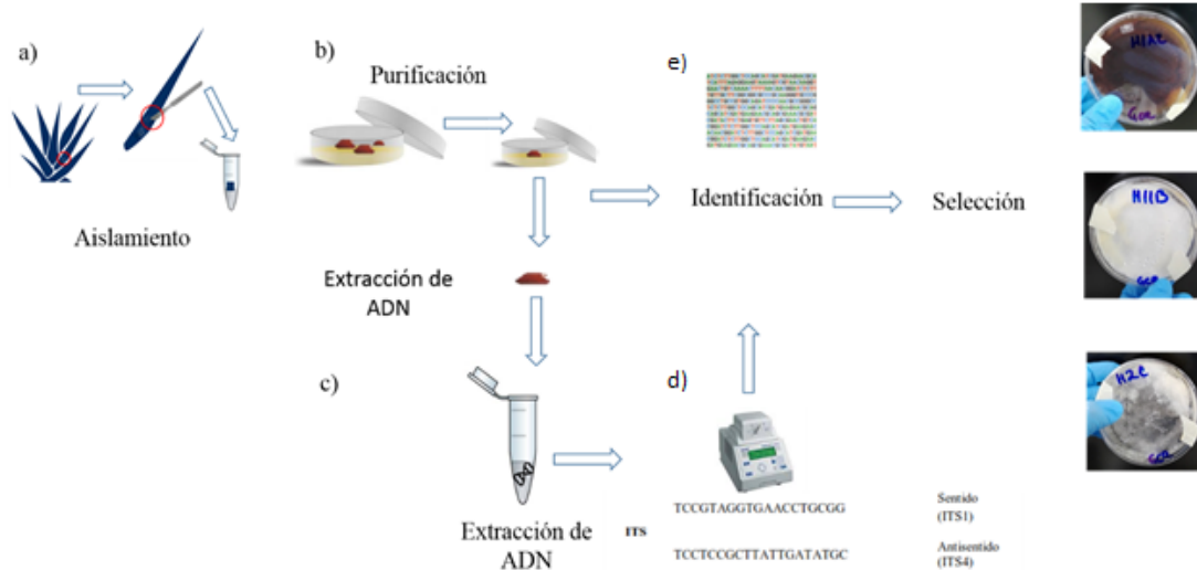
Figura 2.2. Esquema de la metodología utilizada para realizar el aislamiento e identificación de microorganismos asociados a A. tequilana var. azul. a) estrategia de aislamiento del tejido con síntomas de enfermedad; b) Aislamiento y purificación de microorganismos a partir del tejido colectado; c) extracción de DNA de cultivos puros para la identificación molecular de los microorganismos aislados; d) amplificación de las regiones ITS y 26S; e) secuenciación y análisis bioinformático para la identificación.
