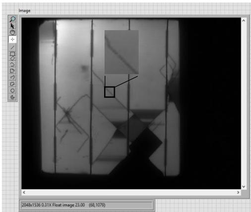
**Figura 4.27** Selección de región de interés en una imagen de electroluminiscencia, sobre una fisura para zona 5.
