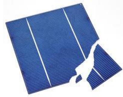
**Figura 1.3** Celda solar rota. [55]
