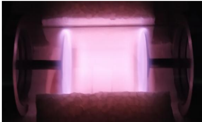
Figura 3.1 Imagen del proceso de activación con plasma de argón.
