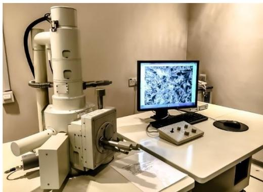
**Figura 2.4** Microscopio electrónico de barrido JEOL JSM-6360LV.
