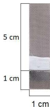
Figura 2.6. Ejemplo de un electrodo de trabajo terminado. Dimensiones de  $6 \times 1 \text{ cm}^2$ .
