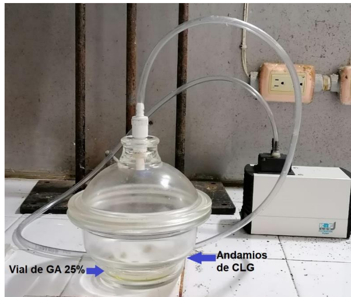
Figura 2.4. Montaje del sistema para entrecruzar los andamios de CLG con GTA.
