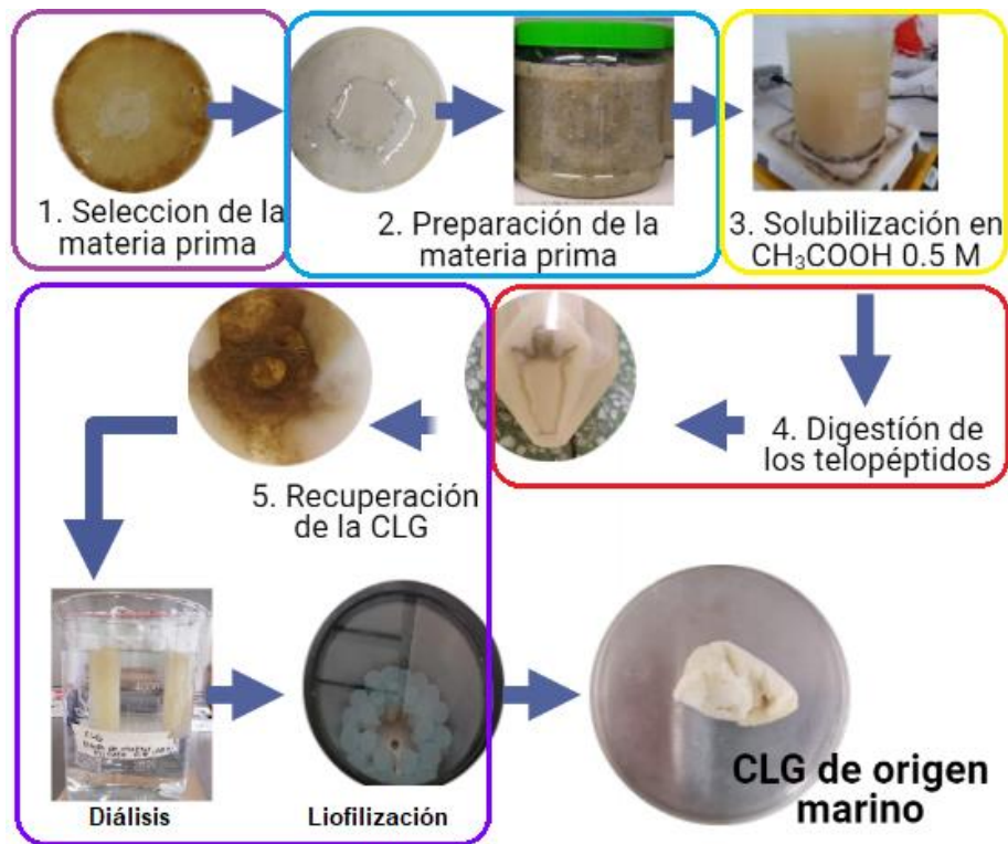
Figura 2.3. Diagrama esquemático del proceso de extracción de la colágena de origen marino.
