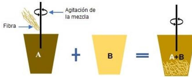
Figura 2.8. Proceso de preparación del espumado con fibra.
