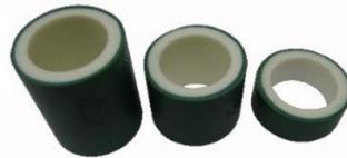
Figura 2.6. Moldes para la elaboración de muestras para ensayos de pull-out.
