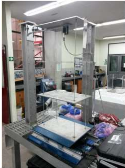
Figura 2.5 Modelo tridimensional utilizado en pruebas sísmicas en la Quanser Shake Table II [83].
