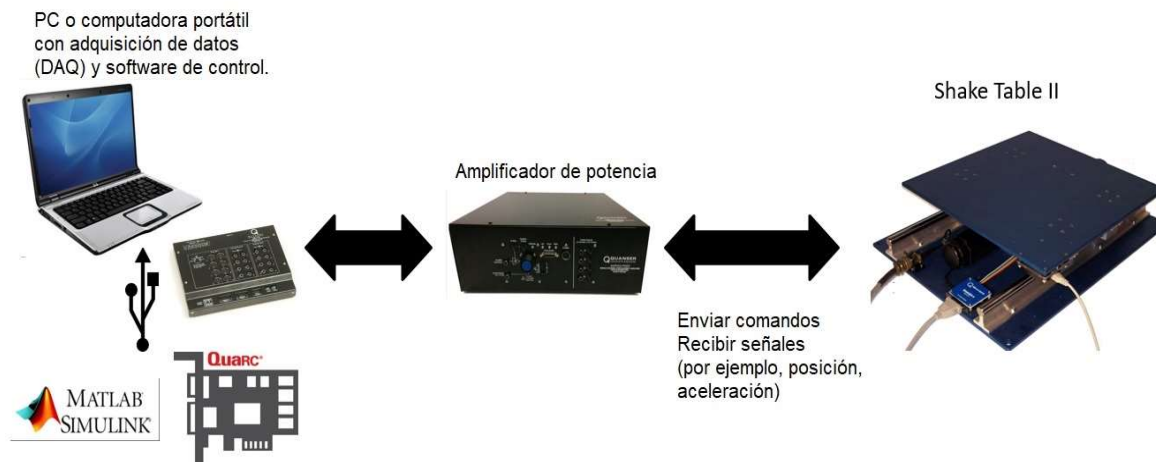
Figura 2.4 Componentes de la Shake Table II para su correcto funcionamiento [86].
