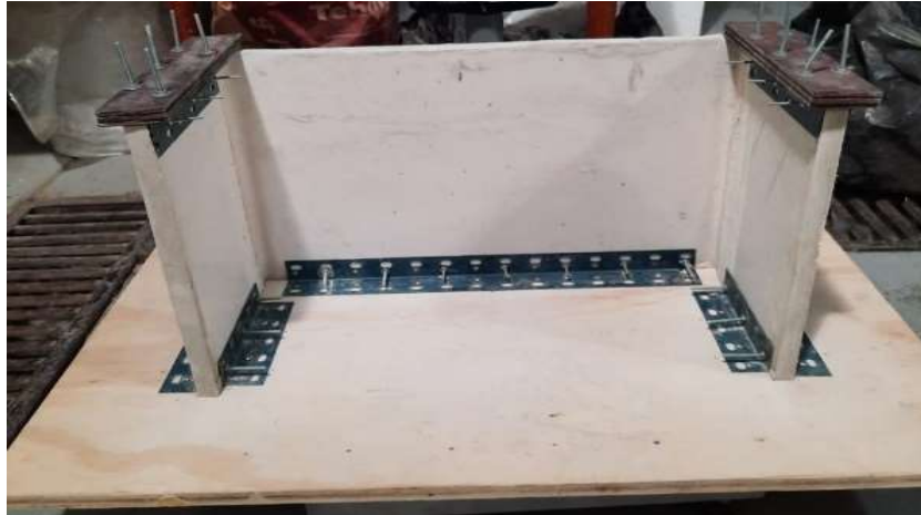
Figura 3.6 Anclaje de muro a la base y pesas sobre el muro.
