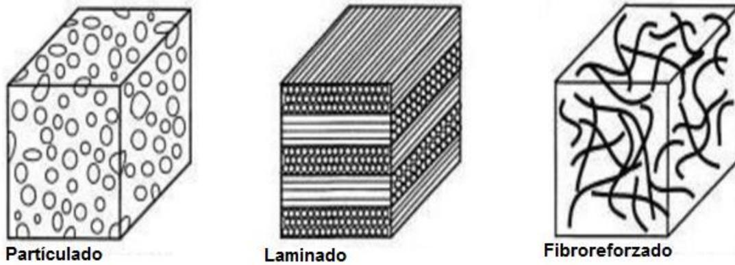
**Figura 1.3.** Clasificación de materiales compuestos [32].
