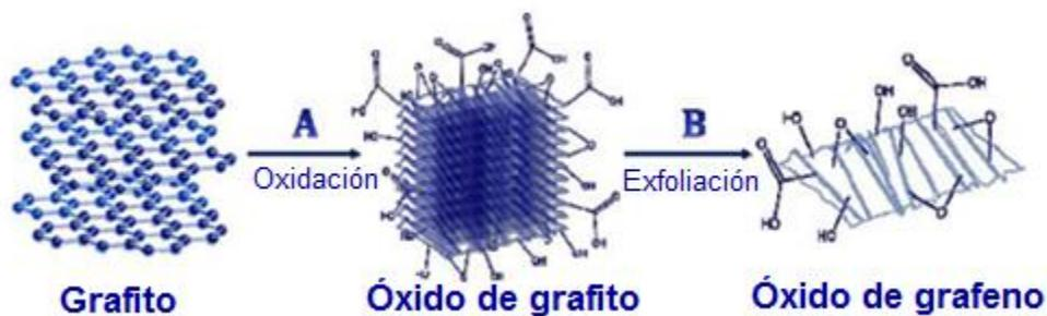
**Figura 1.1** Esquema del proceso de obtención del óxido de grafeno [26].
