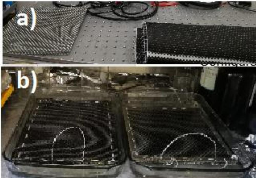
**Figura 2.2.** a) Corte de las Fibras de Carbono y b) Tejido de fibras colocado en las cribas para el proceso de oxidación.
