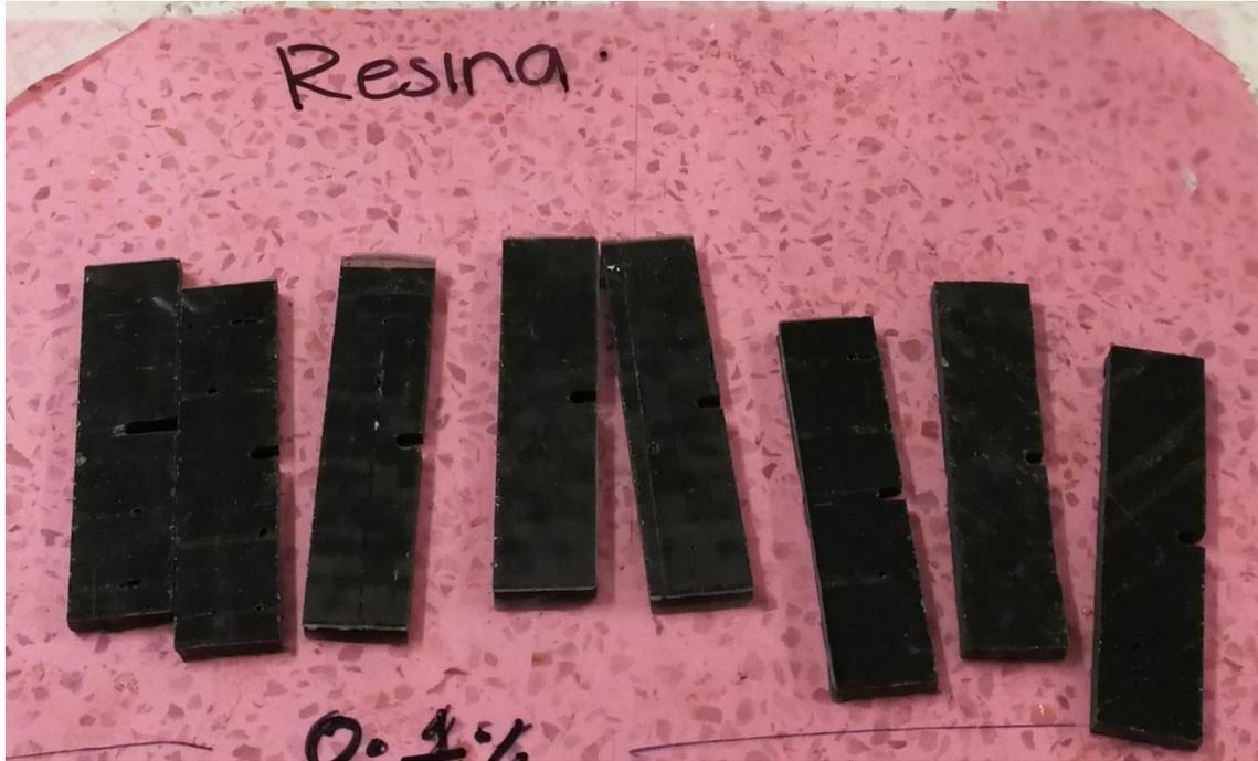
**Figura 2.11.** Probetas de FC / resina epóxica.
