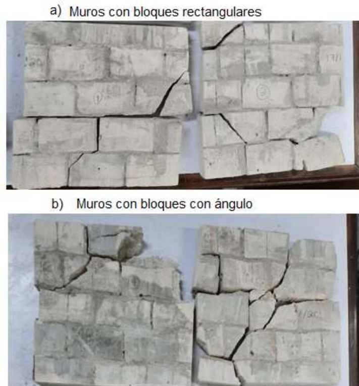
Figura 4.2 Muestras de muros de a) bloques rectangulares y b) bloques con ángulo después de la prueba de compresión diagonal.
