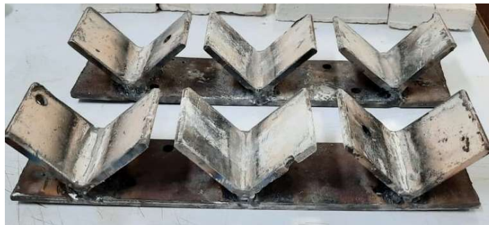
Figura 3.7 Soportes para prueba de compresión diagonal
