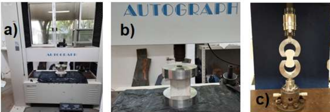
Figura 3.10 a) Máquina Shimadzu AG1, b) Prueba de compresión, c) Prueba de tensión
