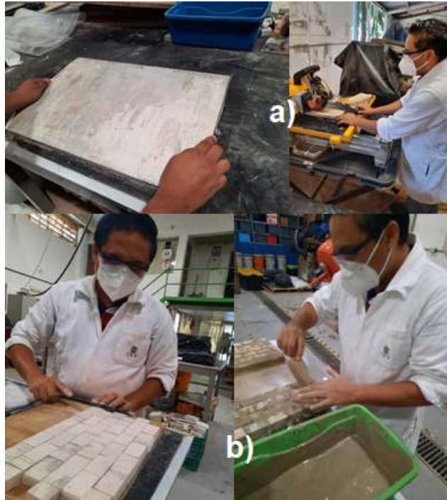
Figura 3.4 a) Placas de concreto espumado y corte de las mismas, b) Elaboración de muros de bloques con concreto espumado
