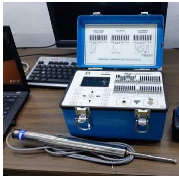
Figura 1.15 Transformador diferencial variable lineal (LVDT) para el sensor de movimiento
