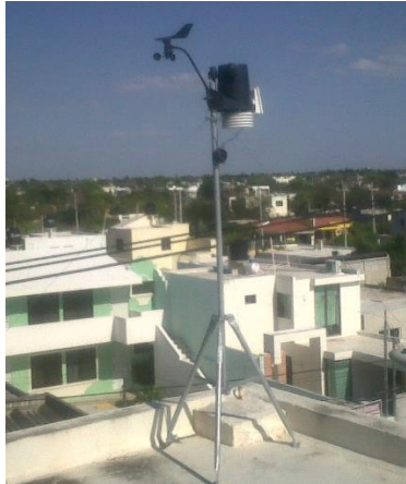
Figura 3.4. Estación meteorológica Davis instalada en CICY.
