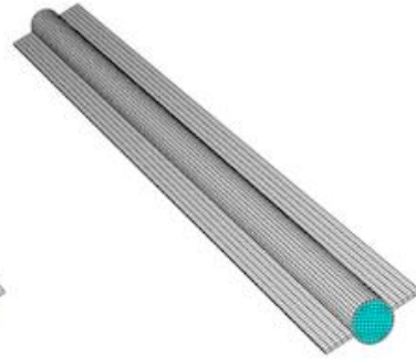
Figura 3.14. Mallado de las distintas geometrías analizadas; (a) receptor sin aletas, (b) receptor con aletas segmentadas y (c) receptor con aletas continuas.
