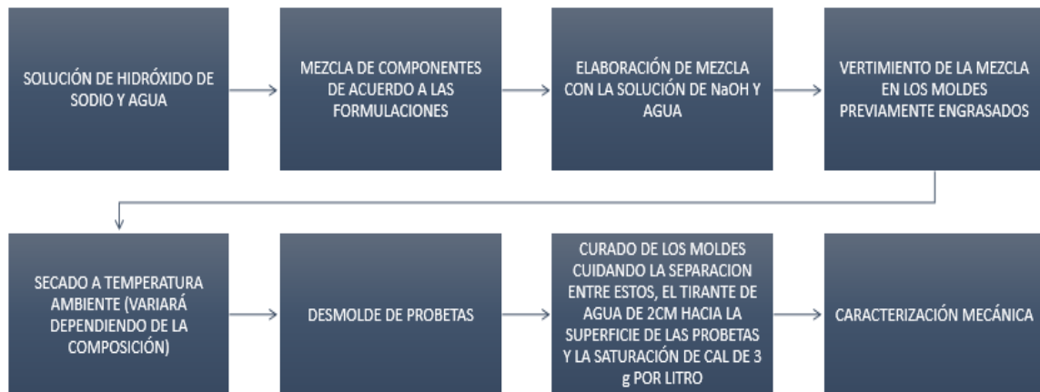
Figura 2.14. Esquema-resumen de la elaboración de las probetas a 7 y 14 días
