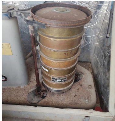
Figura 2.8. Tamizado y cribado del polvo fino
