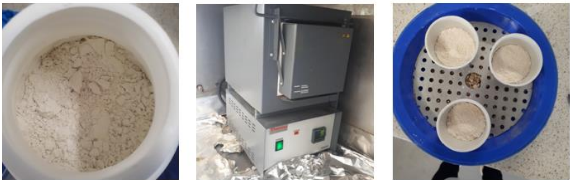
Figura 2.3. Proceso de calcinación del caolín.
