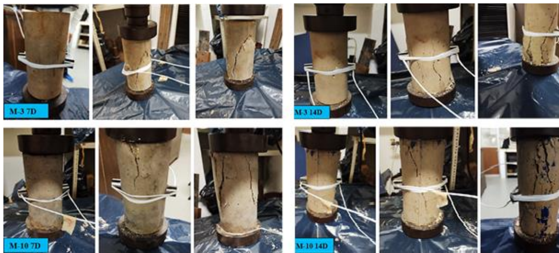
Figura 3.23. Falla por tensión y falla por cortante, en formulaciones M-3 Y M-10 a 7 y 14 días de curado.
