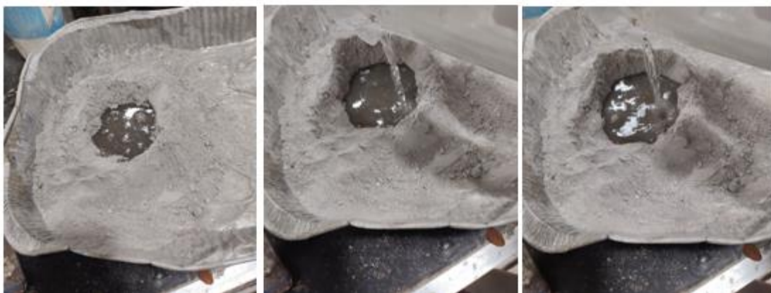
Figura 2.11. Vertimiento de la solución de NaOH con una concentración de 10 M para la elaboración de la mezcla.
