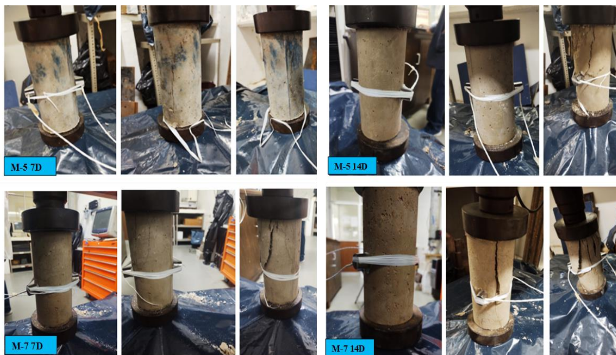
Figura 3.24. Falla por tensión en el material originada por los esfuerzos a compresión en probetas M-5 y M-7 con tiempos de curado a 7 y 14 días.
