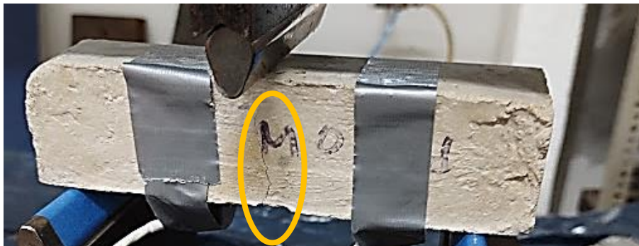
Figura 3.30. Fractura originada en la zona de aplicación de la fuerza
