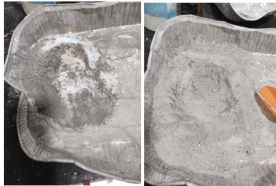
Figura 2.10. Homogenización del polvo fino, PEVA y los materiales cementantes.
