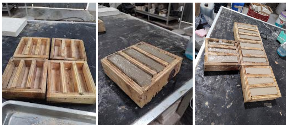
Figura 2.13. Elaboración de probetas prismáticas para pruebas a flexión e impacto.
