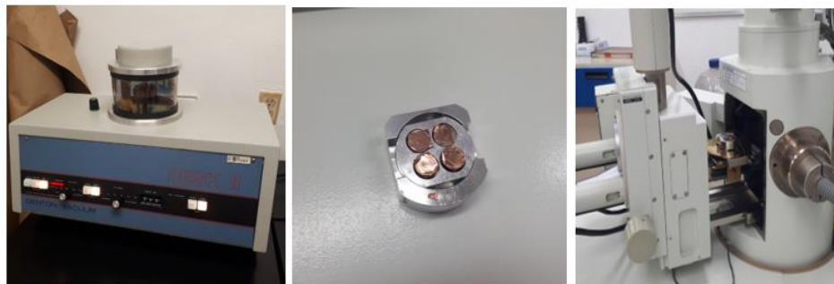
Figura 2.7. Elaboración de muestras y caracterización mediante el empleo del equipo JEOL modelo JSM-6360LV SEM.
