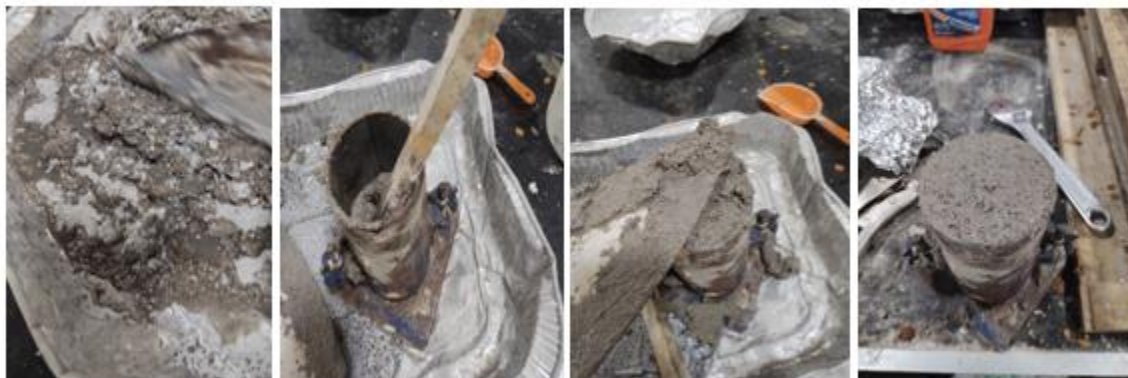
Figura 2.12. Elaboración de probetas cilíndricas para pruebas a compresión.
