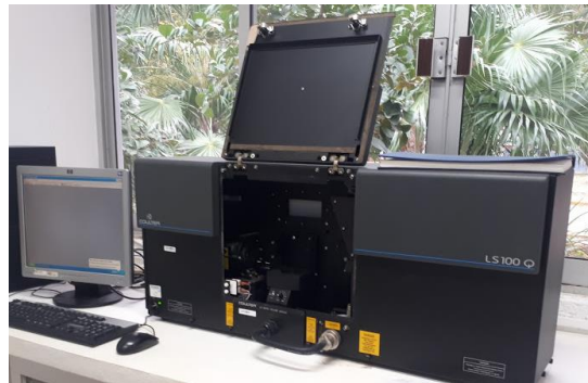
Figura 2.6. Analizador de distribución de tamaño de partículas (Coulter LS 100Q).
