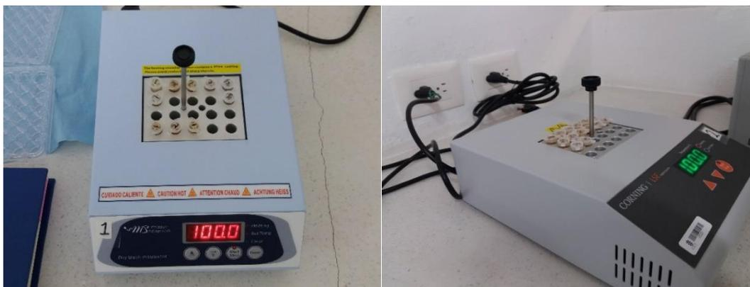
Figura 6. Los micro tubos de “Eppendorf” con los organismos se calienta en un baño ácido a temperatura de 100.0-100.2°C. Foto: Dino Demidof.
