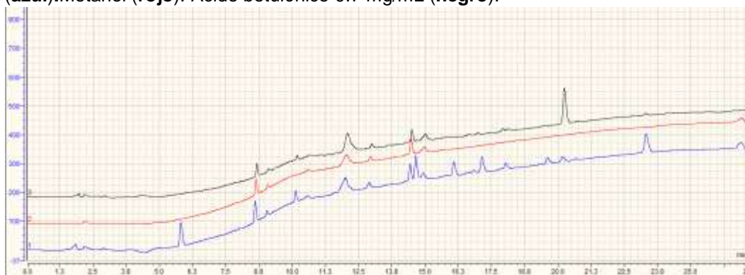
Figura A2.8 Cromatograma de CLAE-FR de 28-O-acetilbetulona. Mezcla de estándares (azul). Metanol (rojo). 28-O-acetilbetulona. 0.7 mg/mL (negro).
