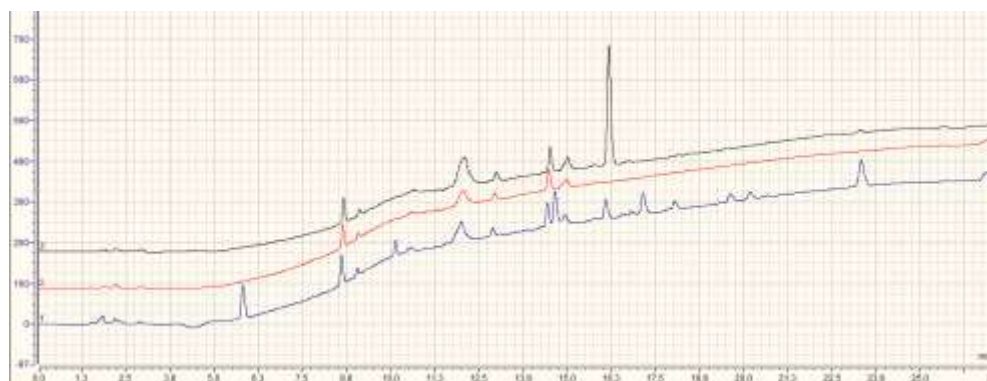
Figura A2.5 Cromatograma de CLAE-FR del ácido 3- epi -betulínico. Mezcla de estándares ( azul ). Metanol ( rojo ). Ácido 3- epi -betulínico 0.7 mg/mL ( negro ).
