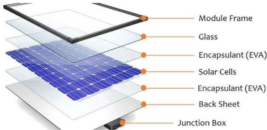
**Figura 1.6** Partes que componen a un módulo fotovoltaico (imagen: EU-India TCP, 2020) [13].
