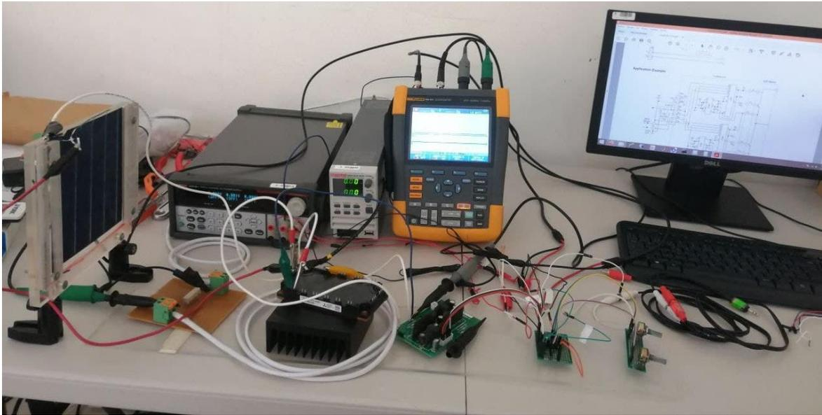
**Figura 3.10** Diseño del circuito de alta corriente para módulos FV.
