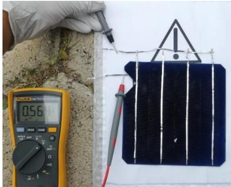
**Figura 2.1** Pruebas de funcionamiento a celda solar seleccionada.
