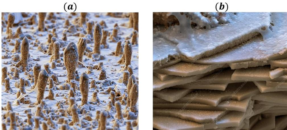
*Figura 3. SEM a color del nácar de la concha del Nautilus: (a) porosidad en la superficie de una plaqueta de aragonita y (b) biopolímero en la superficie de las plaquetas [13].*
