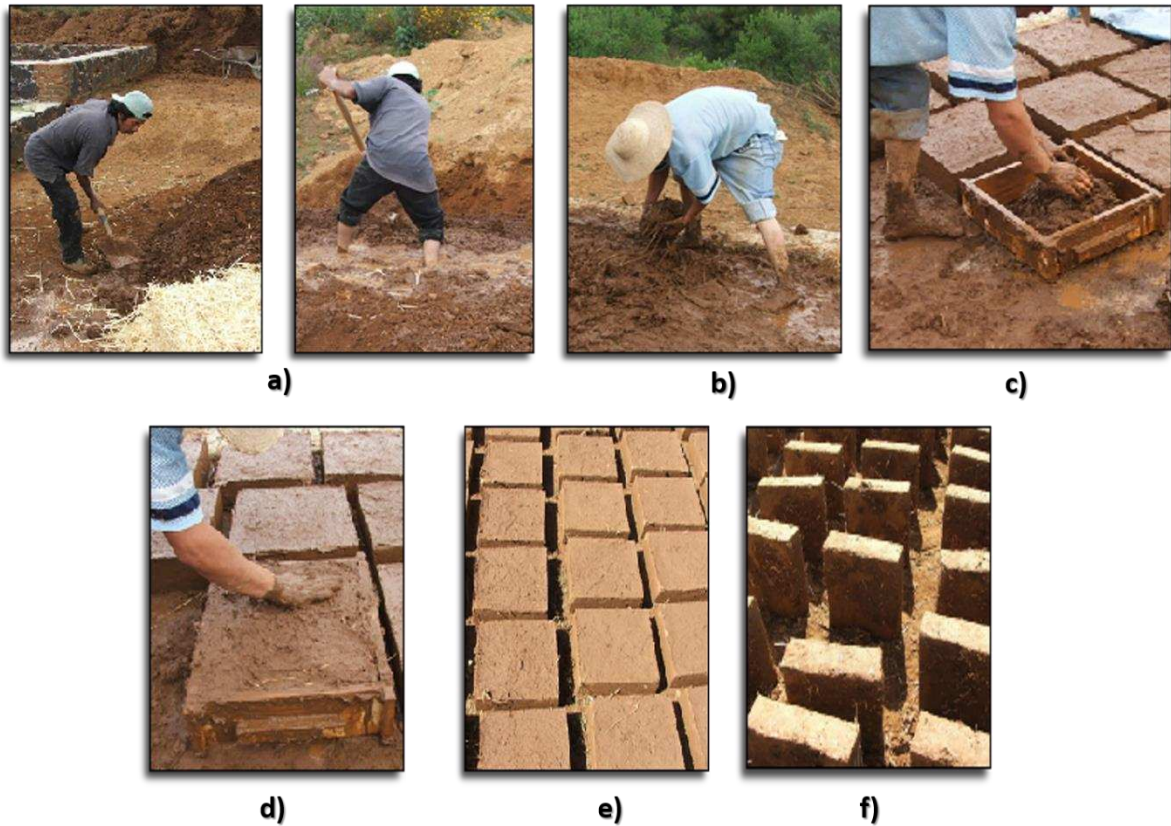
Figura 1.3.- Proceso típico de manufactura de ladrillos de adobe: a) Preparación y mezclado, b) Mezclado manual, c) Moldeado, d) Vaciado y enrasado, e) Primer secado y f) Desmolde y secado.
