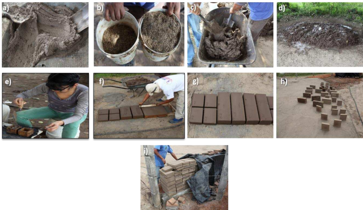
Figura 2.1.- Proceso de elaboración de ladrillos experimentales: a) tamizado, b) picado de las fibras, c) mezcla, d) reposo, e) llenado de moldes, f) engrasado de ladrillos, g) y h) secado y marcado del ladrillo, i) apilado final.
