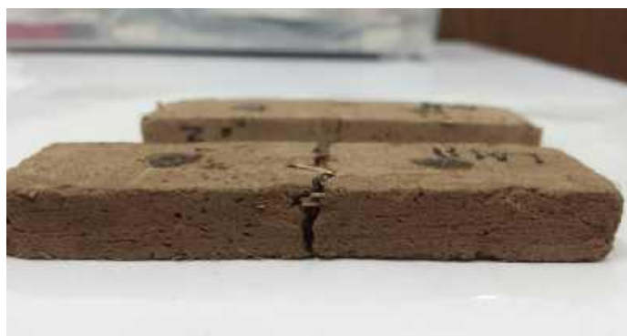
Figura 3.17.- Grietas producidas por el ensayo a flexión de tres puntos.
