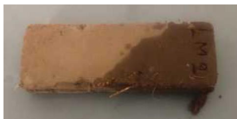
Figura 3.21.- Muestra experimental de serie LM con humedad en sus perfiles.
