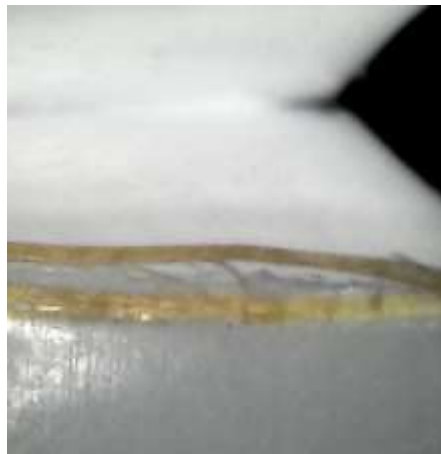
Figura 3.7. Zona de fractura en muestra fibra única orientada transversal a la carga.
