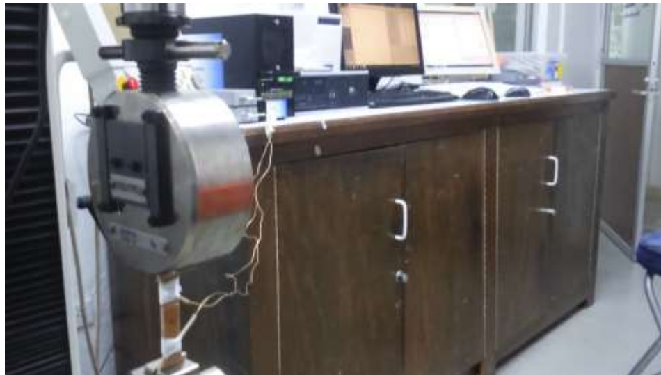
Figura 2.17 Montaje de sensores de E.A. en las muestras.
