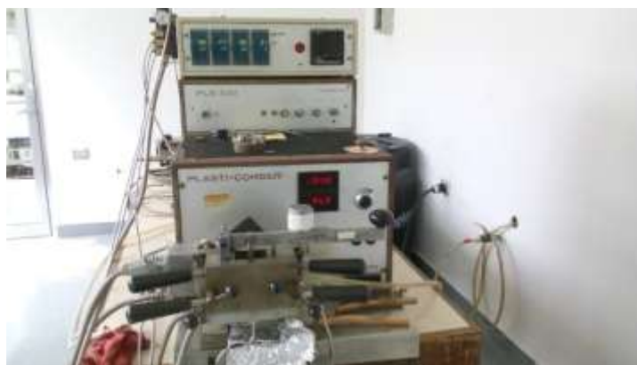
Figura 2.7. Mezclador Brabender Plasticorder PLE330 utilizado para cada mezcla.
