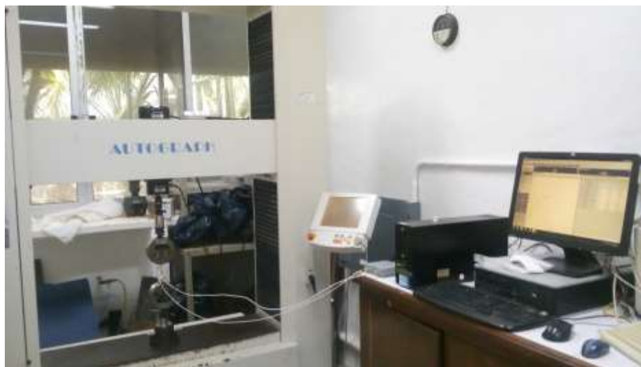
Figura. 2.14 Equipo de E.A. acoplado a SHIMADZU AG I.
