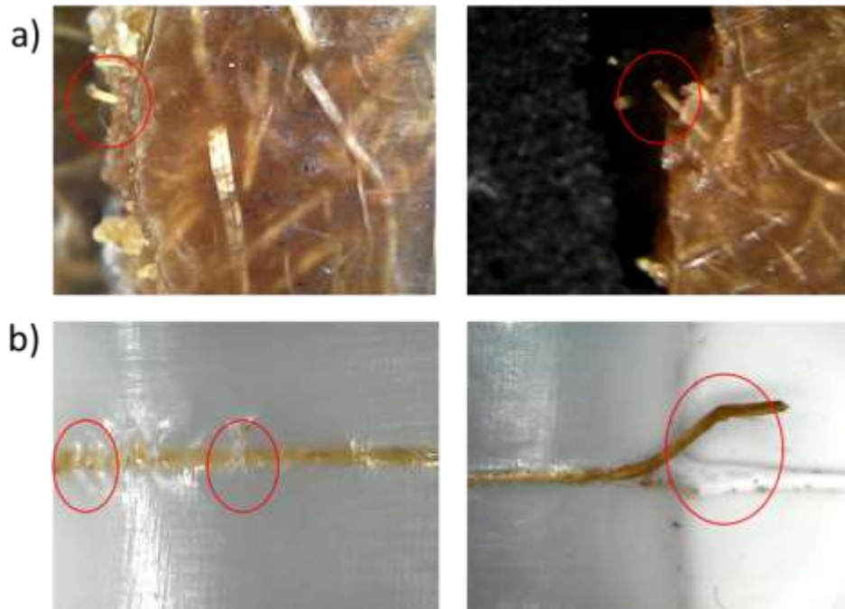
Figura 3.12. Micrografías de la superficie de fractura: a) FIB, b) HDPE-SF.
