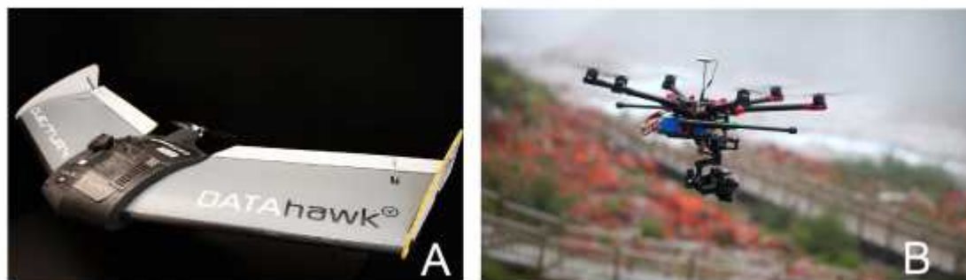
Figura 2. Dos tipos de drones. A. Dron de ala fija que le permite planear (Obtenido de Quest UAV). B. Dron de hélices, que permite volar a diferentes alturas en un solo punto. (obtenido de CAEsoft).
