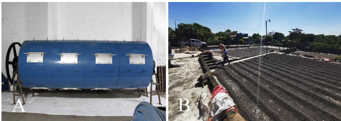
Figura 3. A. Máquina para secar granos de café y B. Patios de cemento amplios para el secado artesanal.
