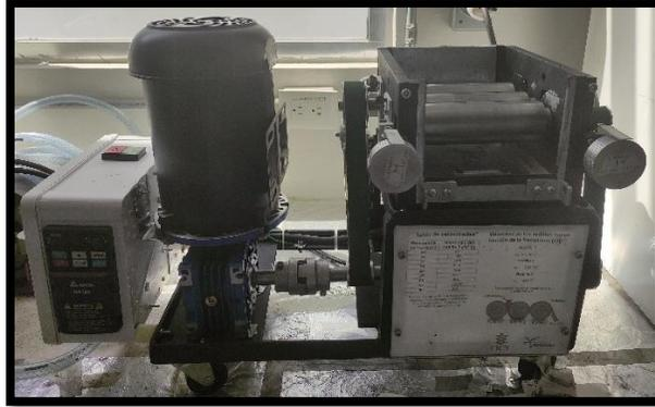
**Figura 2.4.** Molino de 3 rodillos, empleado en la dispersión de nanoestructuras en matriz epoxídica.
