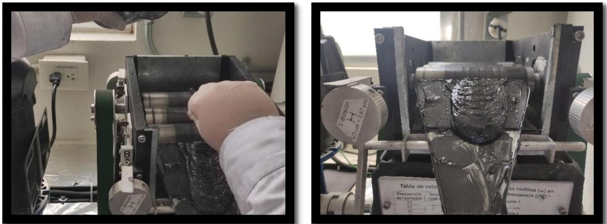
**Figura 2.5.** Proceso de dispersión empleando el molino de 3 rodillos para la obtención de materiales compuestos.
