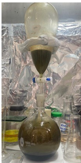
Figura 9. Partición en embudo de separación con fases polar (MeOH/ACN) y no polar (Hx) de E. yucatanensis .
