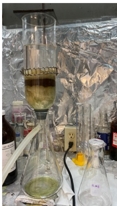
Figura 10. Cromatografía líquida al vacío (CLV) con una fase estacionaria de sílica gel (13 cm de ancho x 5cm de alto) empleando un gradiente de Hx-An.
