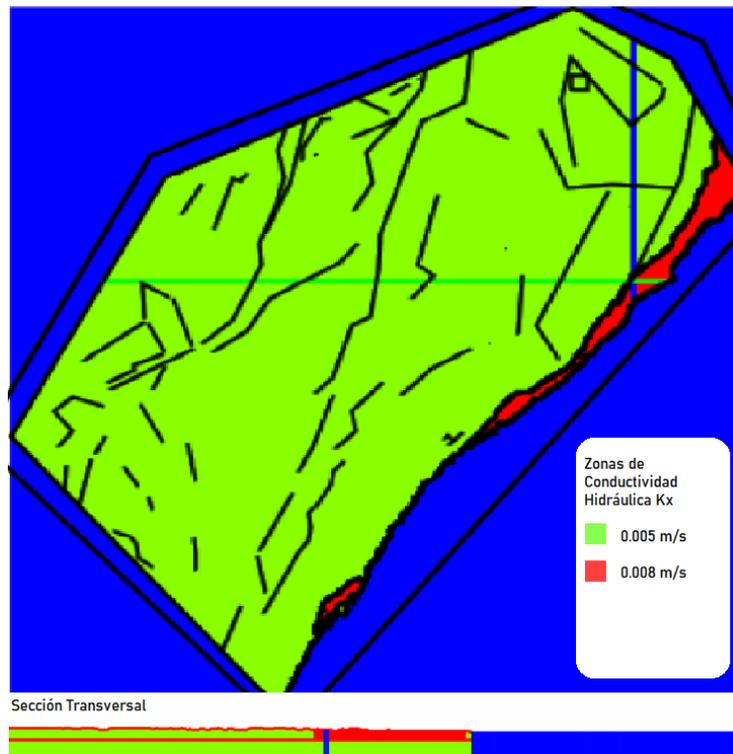
Figura 20. Ejemplo de implementación en MODFLOW del modelo con dos conductividades hidráulicas de acuerdo con el modelo geológico propuesto para la zona de estudio.
