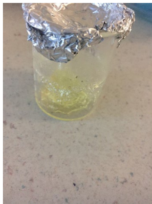
Figura A2. Dendrímeros defectuosos debido al secado.
